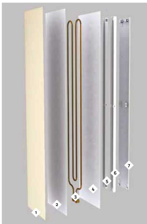
1 - Finition Avant | 2 - Composant polymère | 3 - Plaque de tubes capillaires | 4 - Composant polymère | 5 - Structure support | 6 - Caches latéraux | 7 - Plaque de fixation réfractaire
